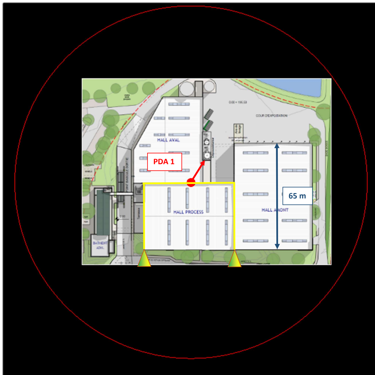
Implantation des paratonnerres, conducteurs de descente et prises de terre.
